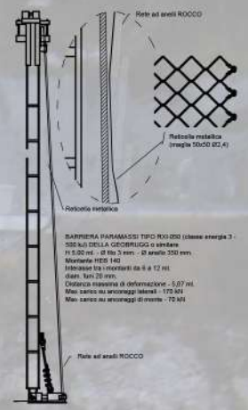
BARRIERA PARAMASSI_Sezione tipo
